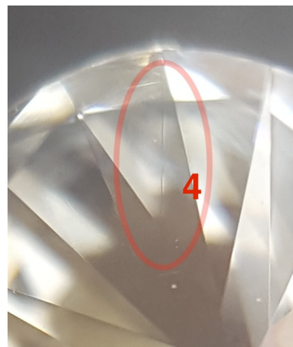
Foto 5b: Een twinning line bij een 0,58 ct LabGrown diamant
