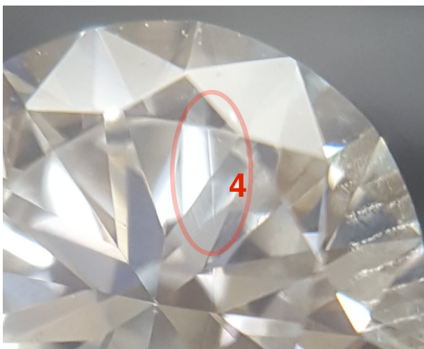
Foto 5a: Een twinning line bij een 0,58 ct LabGrown diamant. Bovenaanzicht.
